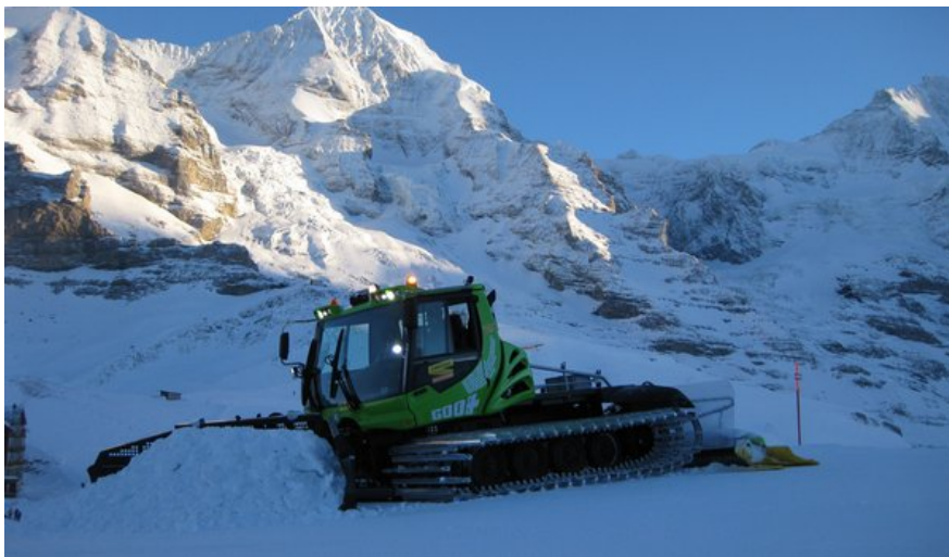
Pistenbully E+ mit diesel-elektrischem Antrieb
