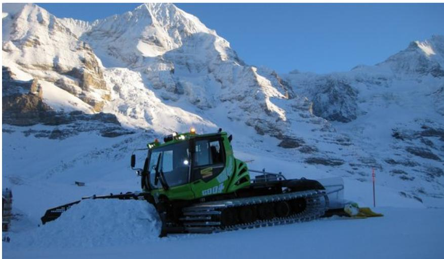
*Pistenbully E+ mit diesel-elektrischem Antrieb*
